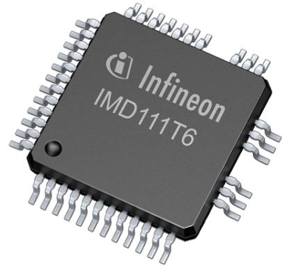
iMOTION™ IMD110-6は、三相モータを制御する高集積ICシリーズです。IMD110は、モータコントローラと高耐圧の三相ゲートドライバと電圧レギュレータを集積し、多種多様なMOSFETやIGBTを駆動します。
