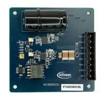
電源を含むすべての電源を供給します。ハイサイドとローサイド間のデッドタイムは初期設定では100nsですが、トリマーポット調整が可能です。外付けインダクタは付属の接続可能なコネクタを使用して接続することができます。出力電圧、バス電圧は最大450Vまで対応しており、コンデンサの定格により制限されます。このハーフブリッジは、12Aの連続電流と35Aのピーク電流をハードまたはソフトスイッチングに切り替えることができます。動作周波数は、トランジスタの損失に応じて数MHzまで可能です(適切なヒートシンクとエアフローでデバイスあたり約15Wに制限されます)。
