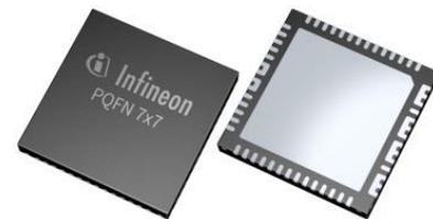
IRPS5401は、コンパクトな7m x 7mm, 56ピンQFNパッケージで、1つのデバイスで複数のレギュレータを置き換え可能な完全統合型PMICソリューションとして開発され、高密度ASIC, FPGAおよびCPUマルチレールシステム、組み込みコンピューティングシステム、通信/ストレージシステムなどのアプリケーション向けです。
