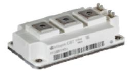
500A / 1700V または 600A / 1200V の62mmハーフブリッジモジュールは、最高の電力密度を実現し、従来と同じフレームサイズでより大きいインバータ出力電力が得られます。この新しい62mm IGBTモジュールは、トレンチ/フィールドストップのIGBT4とエミッタ制御ダイオードを組み合わせたもので、さらに熱伝導材料 (TIM) 付きも提供可能です。
