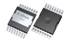
上面冷却では、ドレインがパッケージの表面に露出するため、熱の95%をヒートシンクに直接放熱でき、TOLLパッケージよりもR<sub>thJA</sub>を20%、R<sub>thJc</sub>を50%向上しています。TOLLやD²PAKのような底面冷却パッケージでは、熱はPCBを経由してヒートシンクに放熱されるため、高い電力損失を引き起こします。
