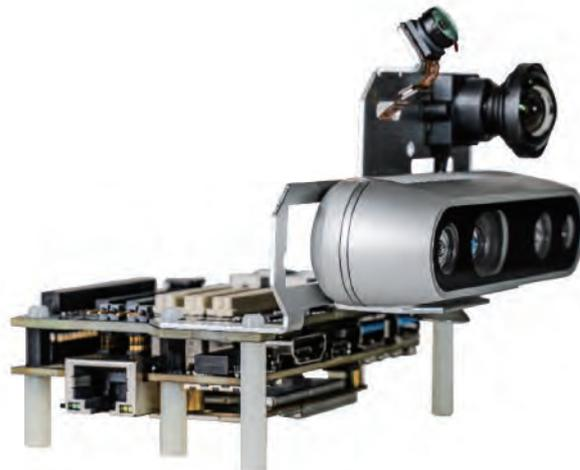
Qualcomm Robotics RB5は、最先端を行く Qualcomm社がAIと5Gの技術をふんだんに盛り込んだ最も革新的なプラットフォームです。RB5 プラットフォームは、QRB5165チップセット(SoC)を使用したRoboticsにフォーカスした開発ボードです。また、汎用的な96ボード(オープン規格)に準拠しており、Mezzanieボードによって幅広く拡張することが可能でプロトタイピングに適しています。RB5はスマートで効率に優れ、コスト効率の良いロボット開発をサポートします。高性能なヘテロジニアスコンピューティングアーキテクチャの恩恵を活かし、AIエンジンによるエッジ推論処理、コンピュータビジョン (CV)、強固なセキュリティ、マルチメディア、WiFiやセルラーなどのコネクティビティを実現します。
