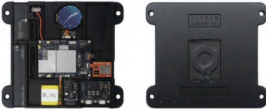
TurboX SDW4100評価キットは、Qualcomm Snapdragon 4100 ウェアラブルプラットフォームと TurboX Wear OSで構成され、主要なウェアラブルデバイス向けの機能をAndroid上で提供します。豊富なインターフェースと周辺をサポートし、モジュラー設計となっているため、開発者はFPCを再デザインすることで、コンポーネントのカスタマイズが可能です。本評価キットは、標準ソフトのベースラインも含んでいるため、開発者は性能評価に専念したり、ウェアラブル商品のプロトタイプを迅速に実現するなど、開発を加速させることができます。
