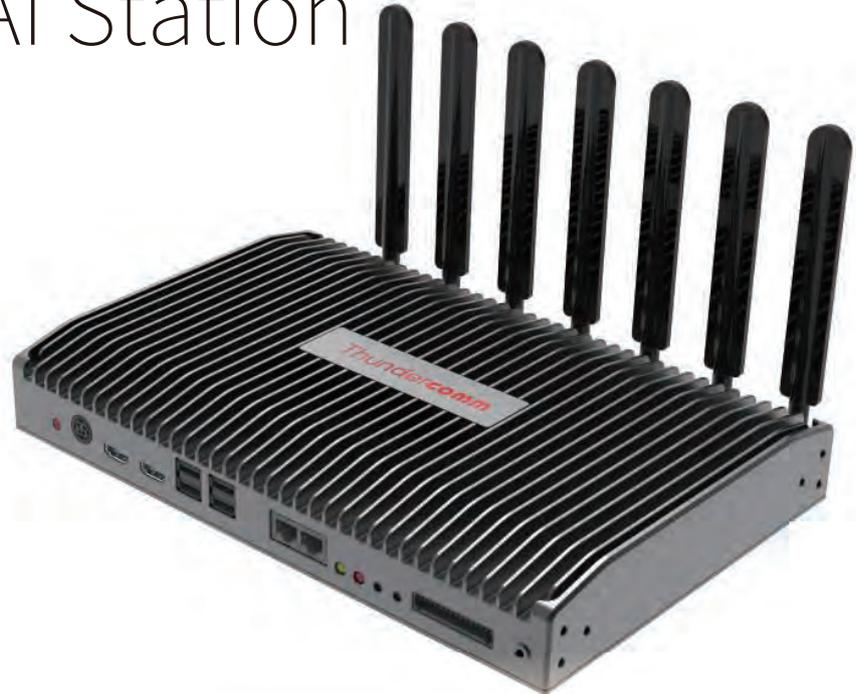
EB6エッジAIボックスは、エッジコンピューティングデバイスとして強大なAI処理性能を保有します。SoC上の15TOPSにプラスした専用推論アクセラレータによって、さらに70TOPS、合計85TOPSの推論性能を発揮する他、インダストリアルデザインによって信頼性と堅牢性を確保しています。強大なAI処理性能とOsware.Edge が組み込まれ、エッジ-クラウドソリューション、AIアルゴリズムやアプリケーションのリモートデプロイ、FOTAなどが様々なフィールドでのアプリケーションを実現します。スマートヘルスケア、スマートビルディング、スマート電力網、スマート交通監視、スマートファクトリーなど多くの複雑なユースケースをカバーします。
