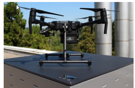
WiBotic は、次世代の自律型ロボットのためのダイナミックなワイヤレス充電ソリューションを提供
