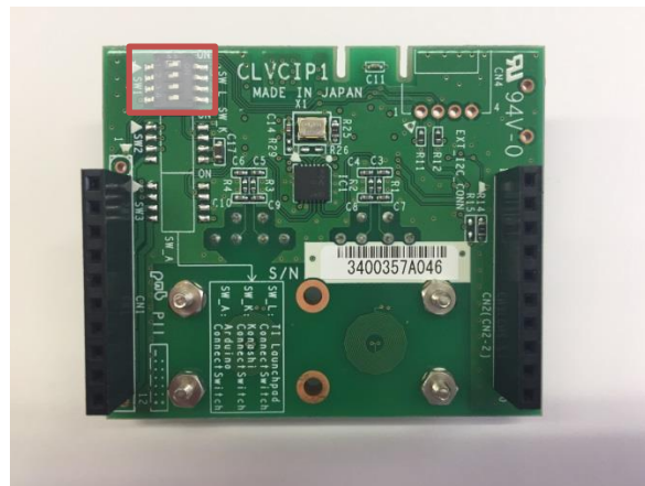
図 5 CC3200MOD LaunchPad 接続時のスイッチ設定図
