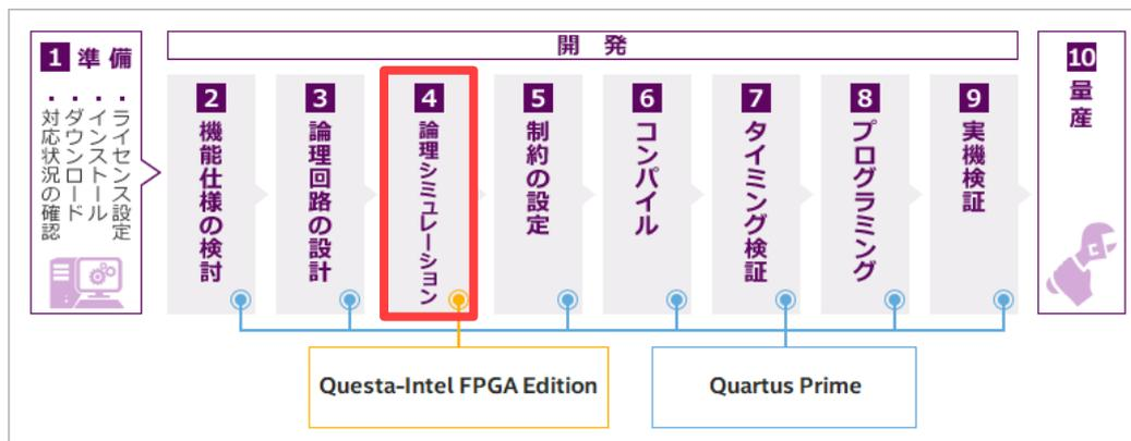
シミュレーションを行うには、検証するデザインに対して入力する信号と出力した信号をモニターする内容を HDL 言語で表現した “テストベンチ” が必要です。テストベンチは、仕様に合わせてユーザーが設計します。
