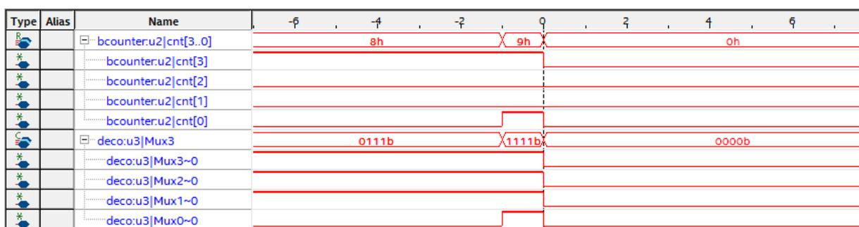
9h は他の信号と比べて継続時間が短すぎるため、LED に表示されないのだと分析できます。リセットの様がおかしいのかもしれませんが、ソース・コードを見て、修正してみましょう。
