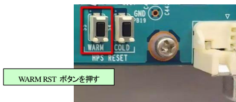
【図 3-10.2】 Sodia の WARM RESET ボタンを押下
