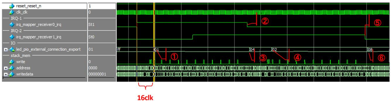
IRQ-1 の処理の途中で IRQ-2 が発生しています。IRQ-1 は IRQ-2 よりも割り込みレベル (RIL) が低いのですが、ネストを許可していないため IRQ-1 が終了するまで IRQ-2 の実行は待たされます。
