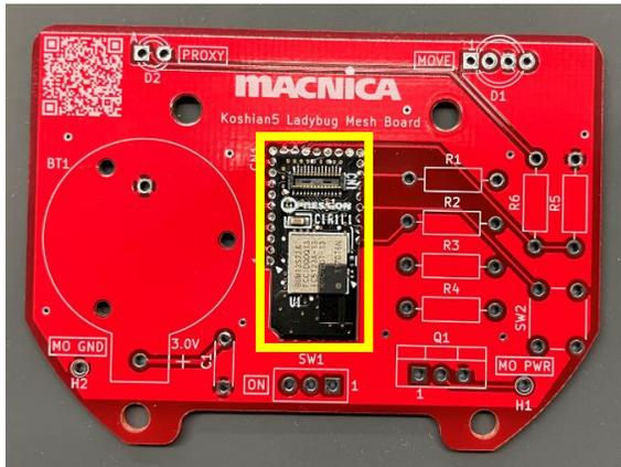
③DIP抵抗、DIPコンデンサをはんだ付けします
