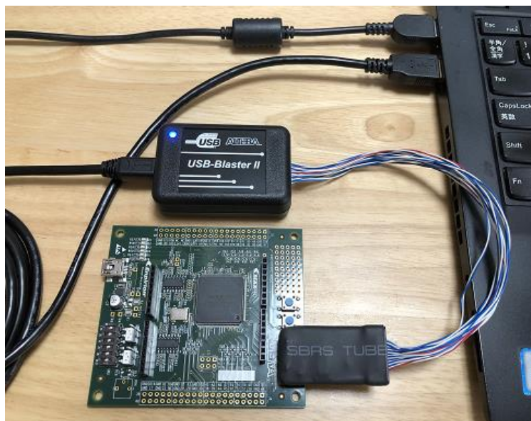
【図 2-4-1】 インテル FPGA ダウンロード・ケーブル II とボードを接続
