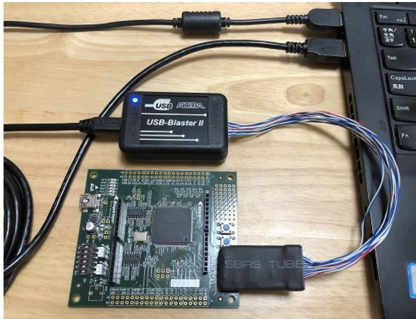
【図 1-5-1】 インテル FPGA ダウンロード・ケーブル II とボードを接続
