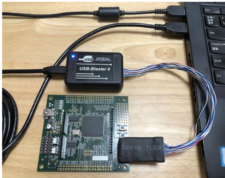
【図 3-4-1】 インテル FPGA ダウンロード・ケーブル II とボードを接続
