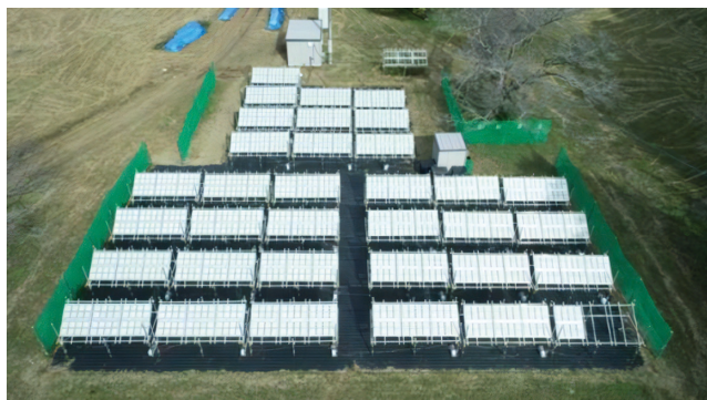
図1 100㎡規模の光触媒パネル反応器の外観
