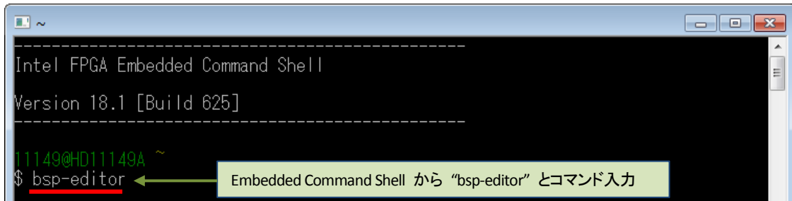
【図 5-1】 bsp-editor (Preloader Generator) の起動
