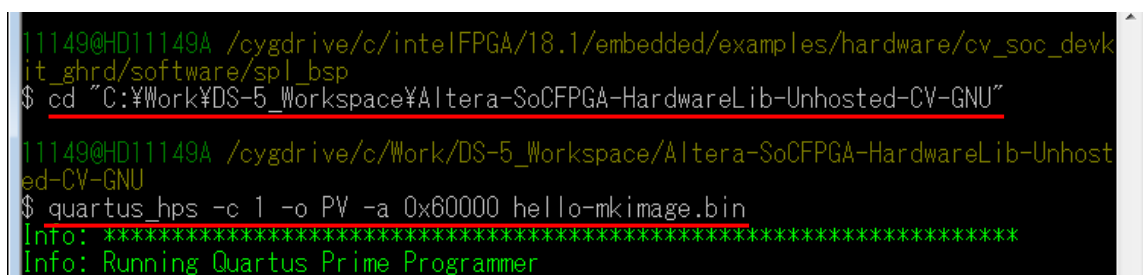
【図 6-3】 QSPI フラッシュへのベアメタル・アプリケーション・イメージの書き込み例
