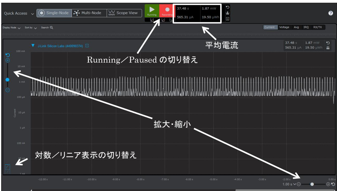
波形上でクリックするとカーソルが出ます。電流のピーク間を測定すると間隔はおよそ 100ms で、その周期でアドバタイズしていることが判ります。
